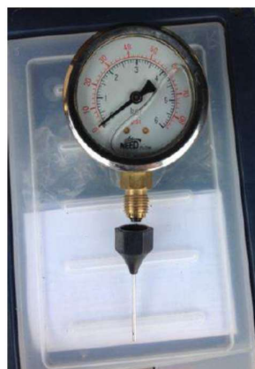
Manomètre à aiguille fine pour prise de pression
