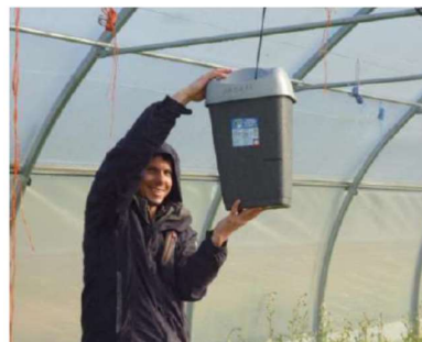
Contrôle de débits sous aspenseurs
