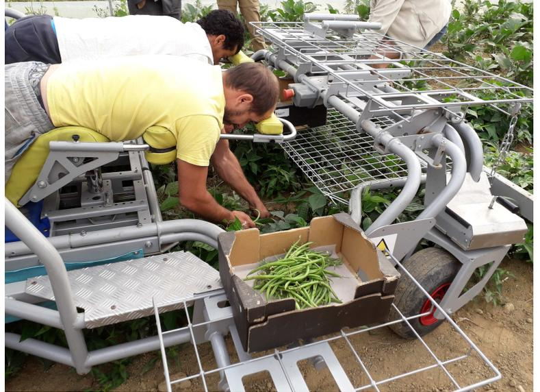
L'autonomie de cet outil 100 % électrique est de 20 h. Il est équipé de 2 moteurs indépendants. Le mode de vitesse intermédiaire permet de varier sa vitesse en fonction de ses besoins et si la vitesse la plus basse est encore trop élevée pour l'utilisateur, le mode Stop and go permettra de passer en dessous de cette vitesse. L'appareil stoppe pendant un temps défini avant de redémarrer automatiquement.
